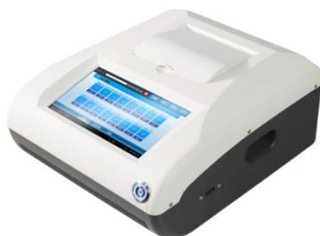
**仪器介绍：**恒温荧光检测仪集成恒温PCR核心技术、实时荧光检测、智能数据判读与实时数据同步分析等技术模块，采用恒温扩增方法，在短时间内扩增样品中的微量病原核酸，荧光探测器检测收集扩增产物荧光信号，实时绘制扩增曲线，并根据设定的阈值自动判断阴阳性结果。
