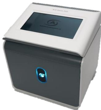
**仪器介绍：**便携式实时荧光定量PCR仪是一款高灵敏度、功能简洁、集恒温PCR技术和qPCR技术于一体的基因分析仪，荧光双通道24孔的小容量规格设计，磁涡流原理加温，升温快速稳定，七英寸电容触摸屏，软件操作简单明了。
